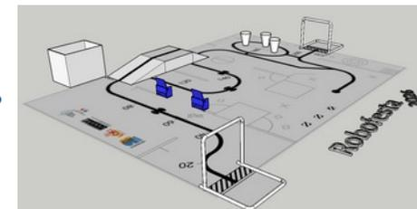
L'objectif du Robot sera de parcourir un trajet semer d'embûches, faire pivoter deux « bascules », puis franchir un pont, ranger trois Ecocup et y verser 1 « balle » dans chacune, « balles » que le robot aura transportées dès le départ, puis finir le trajets par déclencher une « Funny Action ».
